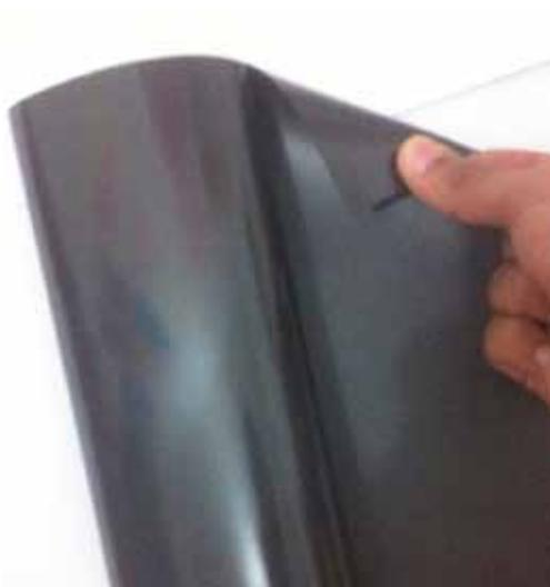
Figuras 145 e 146: peça adesivada com ímã e manta magnética de 0,8mm.
